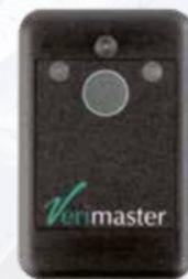
Le dispositif de détection **sonore** ou "CPD" est un détecteur de taille similaire à un porte-clés qui émet un bruit lorsque l'additif est détecté.
